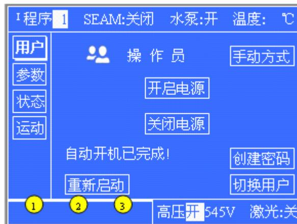
注：报警栏上方对应水泵、泵浦灯、高压的三处空白，会跟随开机的过程，逐渐填充满。如上图中①、②、③处所示。
